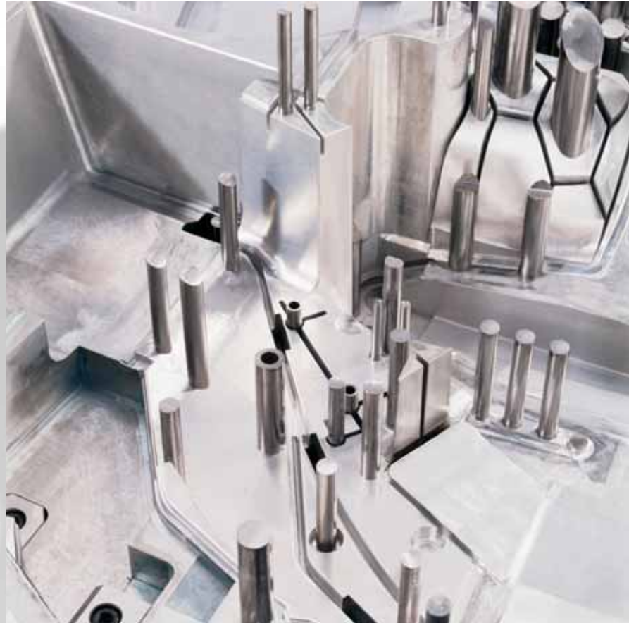
Werkzeugausschnitt (hergestellt durch Laser-Metall-Sintern und konventionelle Bearbeitung) mit Auswerfern
