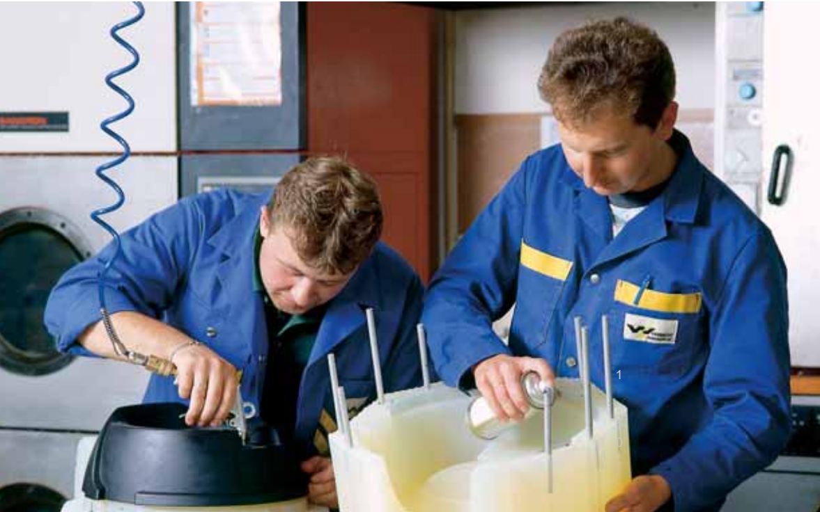
Ausformung eines Prototypen-Vakuum-Abgusses aus einer Silikonform
