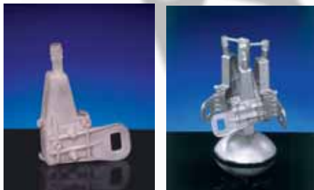
Vom 3D-Datensatz über ein Stereolithographie-modell bis hin zu den fertigen Metallabgüssen in wenigen Tagen.
