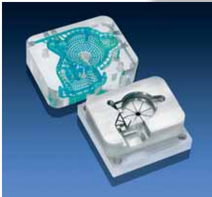
Werkzeugeinsatz in Hybridbauweise mit konturnahen Kühlkanälen zur Reduzierung der Zykluszeit im Serienwerkzeug
