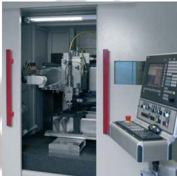
Unsere Laser-Feinschneid-Anlage ist speziell für das Schneiden und Bohren in der Präzisionstechnik konzipiert
